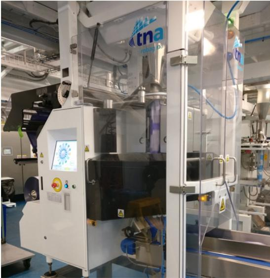
tna robag<sup>FX</sup> 3ci はまた、「シール部に入った製品の検知 (PISD)」用ソフトウェアで、シール部やシール金具内の製品をモニターします。完全シーリングが損なわれたら、システムは直ちにオペレーターに知らせ、その袋をラインから迅速に取り除き検査を行うことができます。これによってパイパーズ・クリスプスは、最高品質基準を満たした袋を生産し、廃棄物を最小限に留めることができます。
